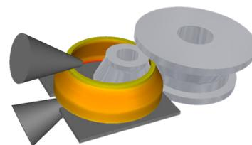
Laminage circulaire radial-axial
