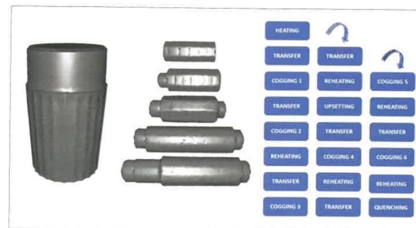
Figure 2 : Séquence de martelage classique à partir d'un gros lingot coulé (image :Transvalor)
