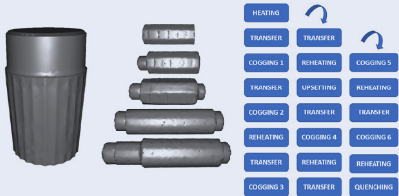
Bild 2: klassische Freiformschmiedesequenz ausgehend von einem großen Gussblock (Bild: Transvalor)
